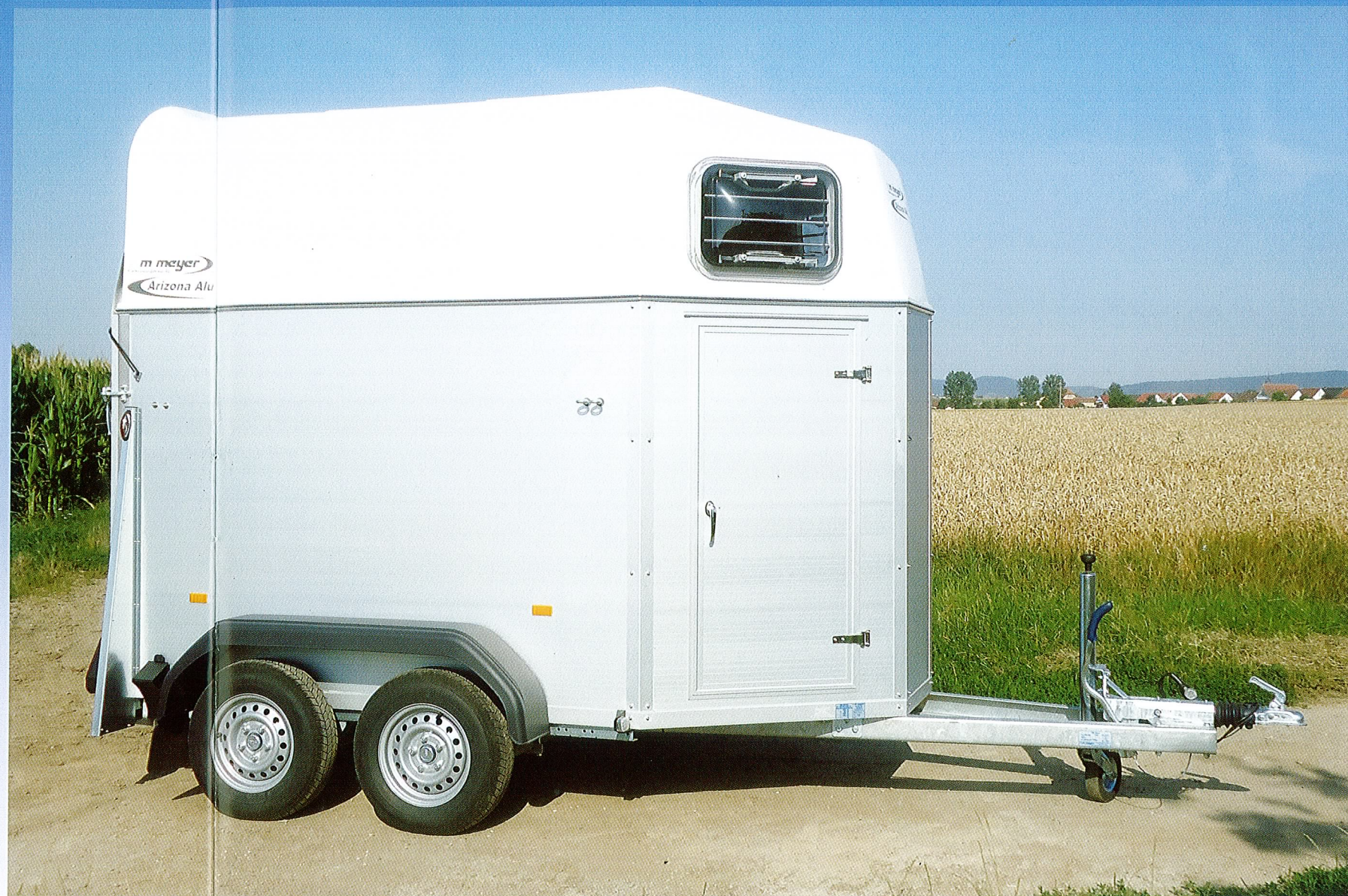
Stützrad verstärkt (klappbar), Aluminiumwände Roue jockey renforcée (automatique), panneaux en aluminium Reinforced jockey wheel (automatic), aluminium side panels
